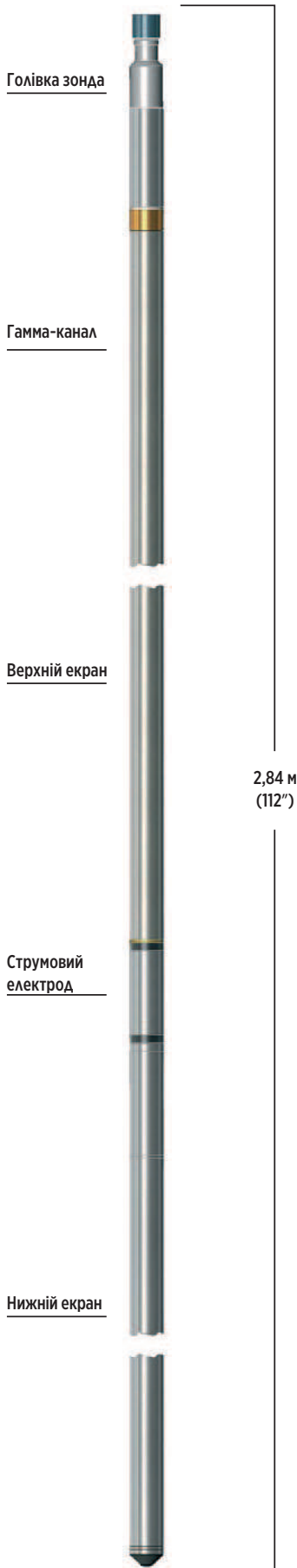
ФОКУСОВАНИЙ ЕЛЕКТРИЧНИЙ ЗОНД (GUARDLOG)
