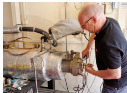
система была испытана при температуре 125°C/12 500 PSI на базе Испытательного центра Hydratron компании Robertson Geo.
