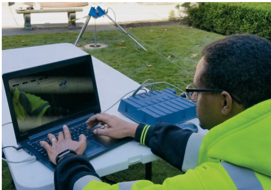
г-н Мерон Окбай MS из Insitu Engineering получает доступ к данным регистратора PS, развернутого в пилотной скважине в Троицкой приходской церкви.
